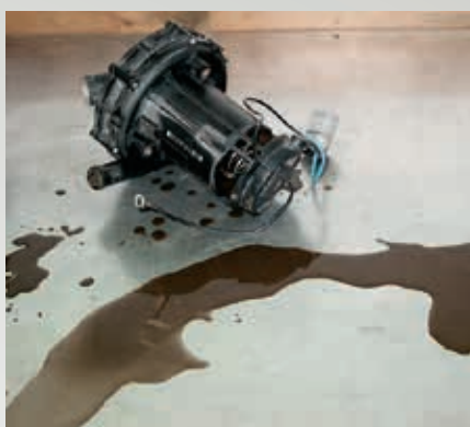
Fig. 28: Condensado en la bomba de aire secundario
