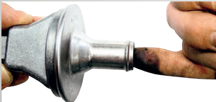
Fig. 32: Sencilla comprobación de la válvula de retención
