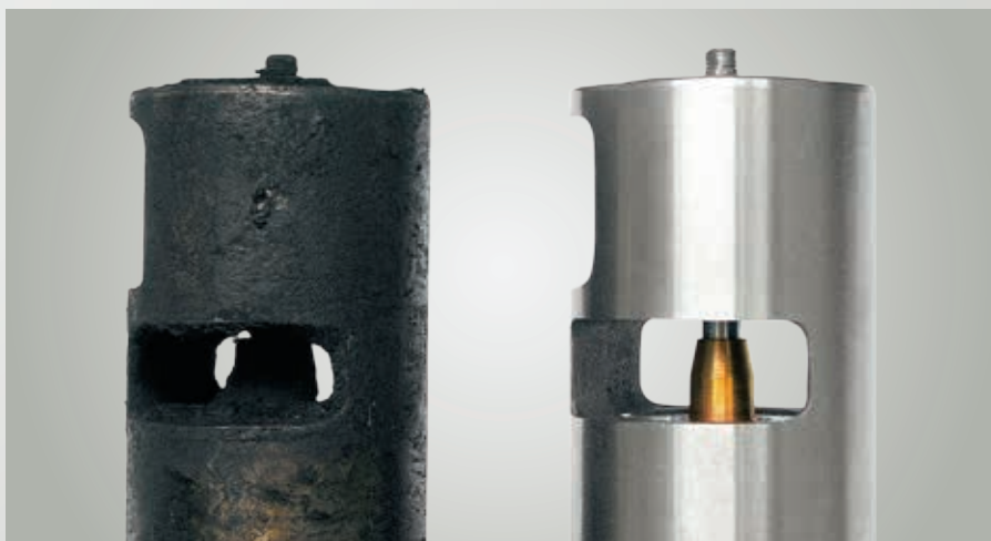
Fig. 38: Válvula EGR (diésel) con sedimentos importantes y en estado nuevo
